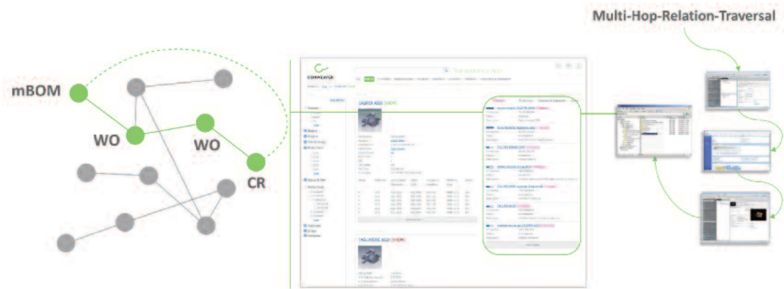
Bild 2: Implizite Relationen werden mittels automatischem Schlussfolgern berechnet. Ein Teil mBOM wird durch eine Arbeitsanweisung WO geändert, welche von einer übergeordneten Arbeitsanweisung WO ausgelöst wurde und diese von einer Änderung CR.
